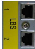
Abb. 3-27 LBS-Anschlüsse 1 und 2 an der Rückseite der USV-Anlage.
