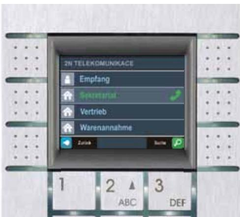
Die 2N EntryCom IP mit Display verfügt über die Leistungsmerkmale der Pro-Version und ist in der Ausführung mit 6 Ruftasten, Code- und Wahl tastatur und wahlweise mit Farbkamera ausgestattet.
