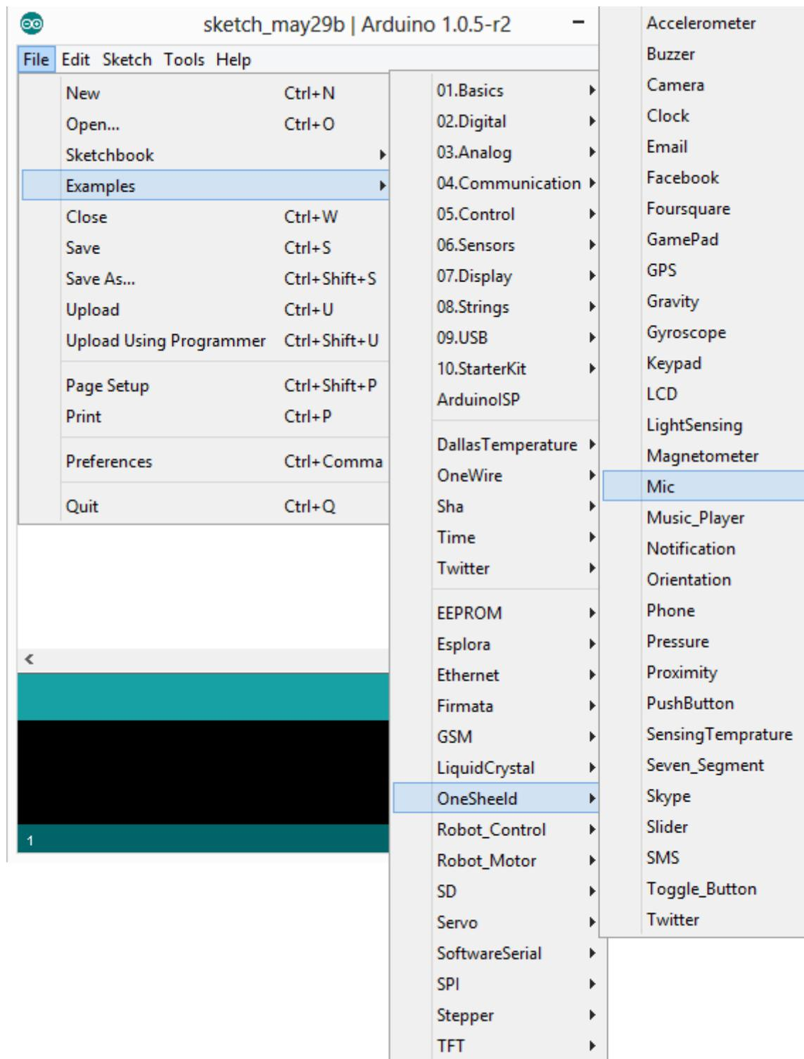
Sie können das Mic-Shield-Beispiel aus dem Beispiel-Tab öffnen, wie oben gezeigt. Anmerkung: Es gibt eine Zwangsverzögerung, die in das Senden von Frames von der 1Shield-Bibliothek (etwa 200 ms zwischen jedem Frame) gesendet wurde, um Sende- / Empfangs-Frames zwischen der Anwendung und dem Arduino zu erhalten.
