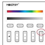
2. Drücken Sie 3 Mal kurz auf einen beliebigen Kanal „1“. Wenn die Verbindung erfolgreich hergestellt wurde, blinkt die DMX512-Master-Anzeigelampe 3 Mal langsam.
