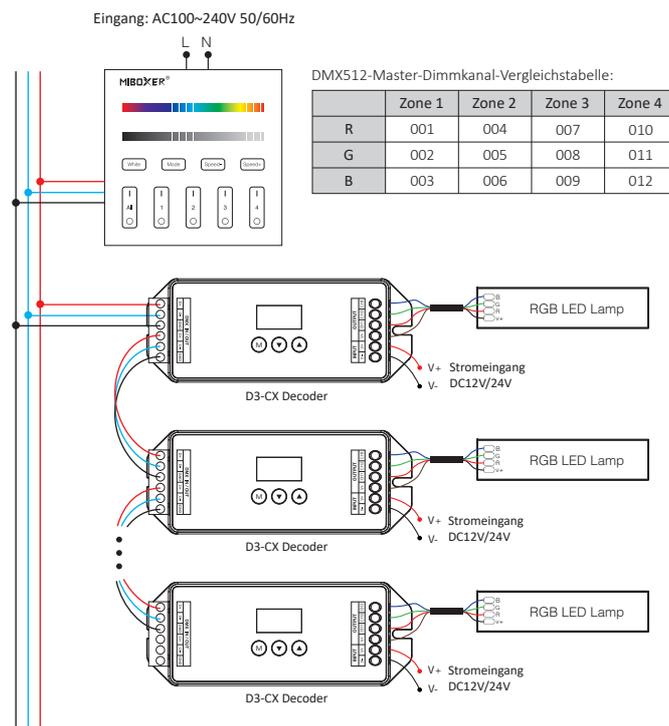
Nach der Verbindung mit DMX Decoder setzen Sie bitte die DMX-Decoder-Adresse wie unten fest:
