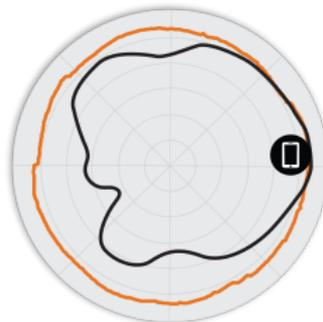
Abbildung 4. 2,4 GHz-Elevation-Antennenmuster
